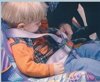
Falsch; zu locker!
